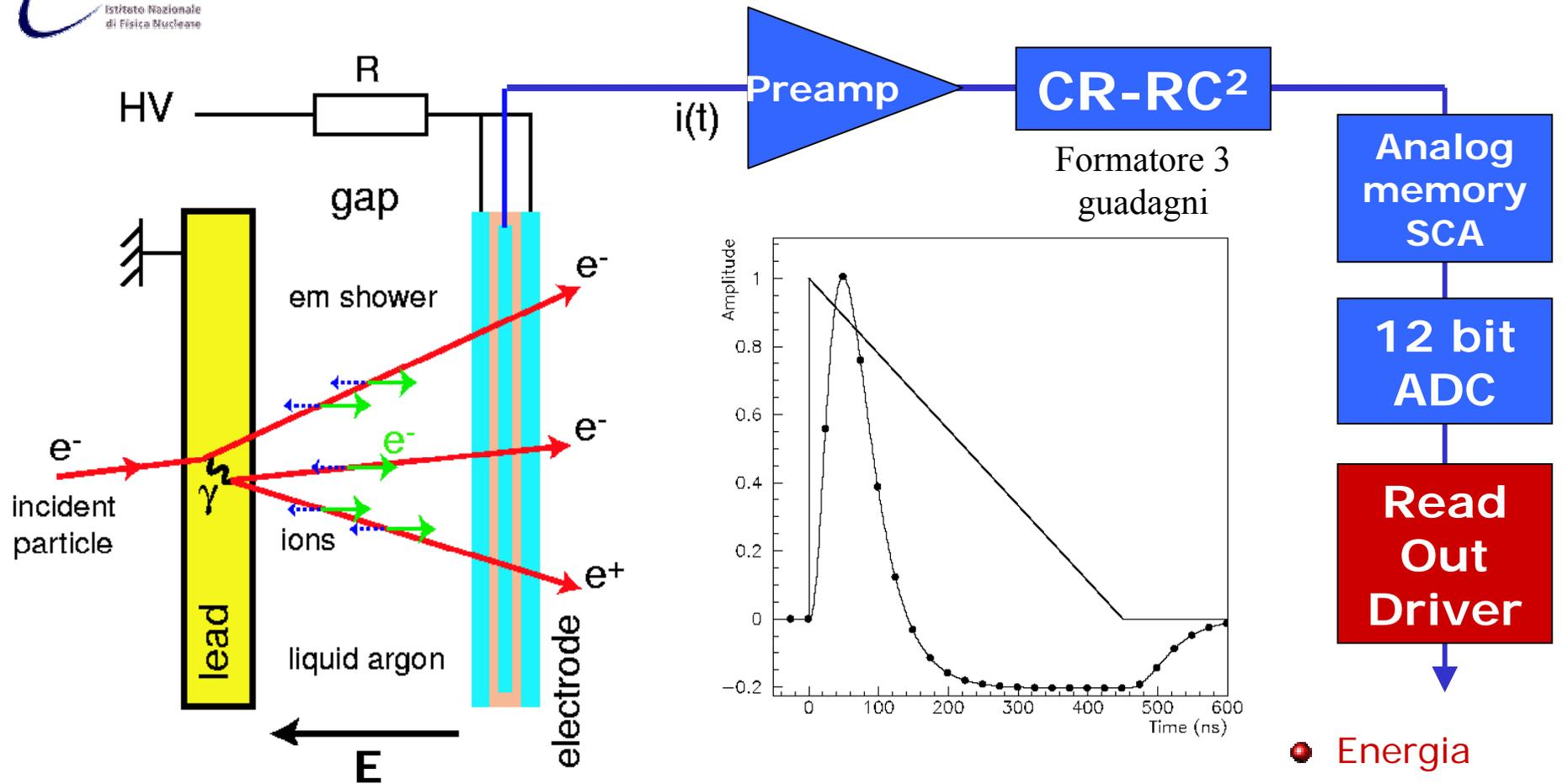
Il segnale triangolare in corrente viene preamplificato e formato da un filtro bipolare del tipo CR-RC<sup>2</sup>.
