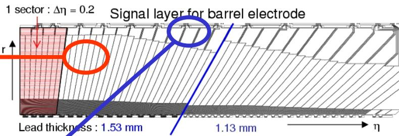
La connessione fra l'elettrodo e le schede di lettura (Summing Board + Mother Board) ha un **elemento induttivo** che dipende dalla cella
